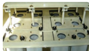
필터 자동 클리닝시스템 (Air Pulse Jet System)
